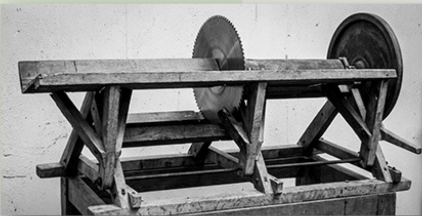
Banc de scie à table basculante. On remarque la roue d'air en fonte, à droite, qui permet de conserver l'inertie de la rotation de la lame de scie, au centre.
