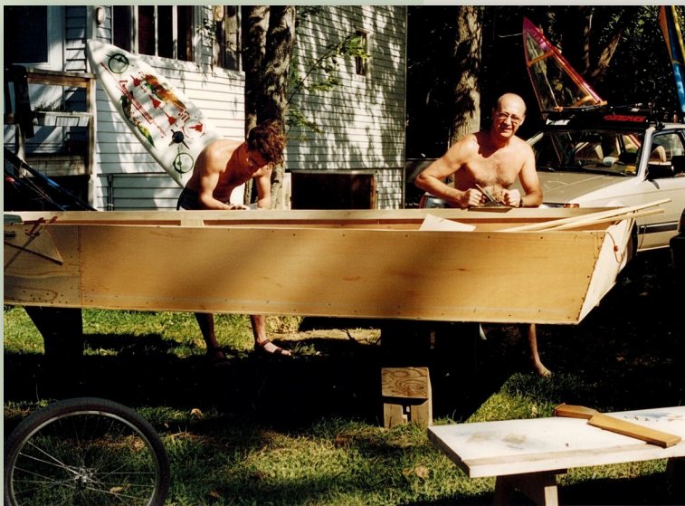
Fabrication d'une chaloupe à fond plat style « Jon Boat » pour la pêche et transformable en cache à canards.
