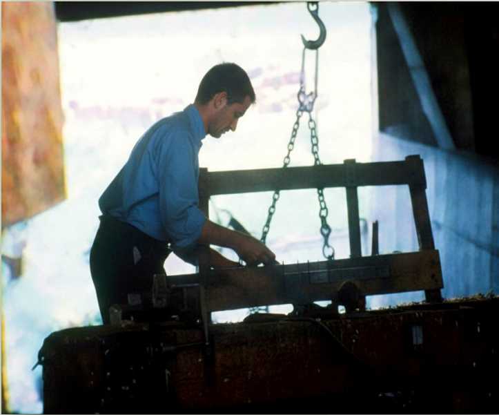
Pierre qui plante les pics de son monte-balles dont la descente est contrôlée par le palenteur.
