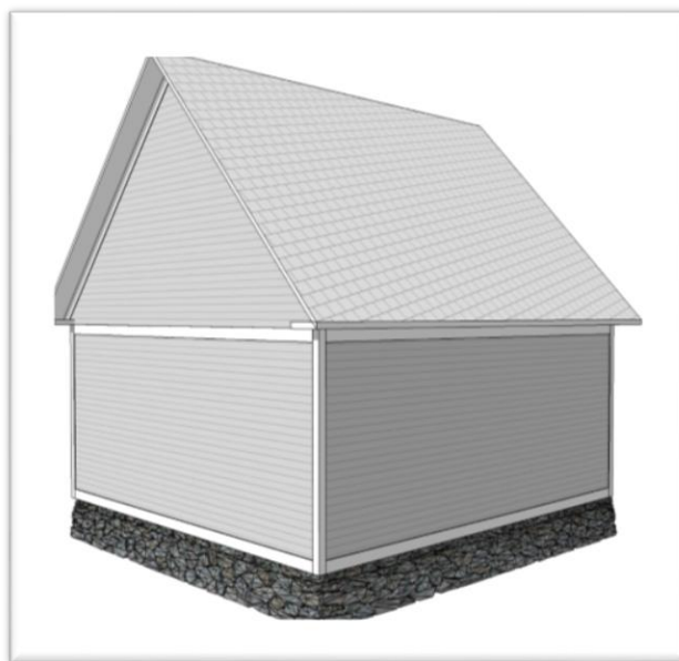
Figure 27: Croquis illustrant la tôle posée à la canadienne recouvrant une maison du type à deux versants droits. Croquis de Daniel Laganière.
