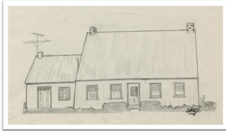
Figure 6: Maison d'Esprit français à doubles versants droits. Carré de pièces sur pièces lambrissé de planches verticales, avec son adjonction en position latérale gauche. Maison sise à Saint-Anne-de-la-Pérade (Mauricie), construite dans la seconde moitié du XVIII e siècle. Aujourd'hui, de profondes modifications en ont altéré sa valeur architecturale. Croquis de Jean-Pierre Chartier.
