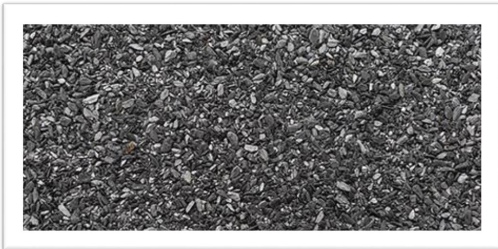
Figure 51 : Revêtement d'asphalte et de gravillon. Il peut occasionnellement s'installer sur un toit plat dans la maison ancienne, dite à façade postiche. La moindre pente pourrait faire migrer trop facilement le gravier vers le bas du versant.
