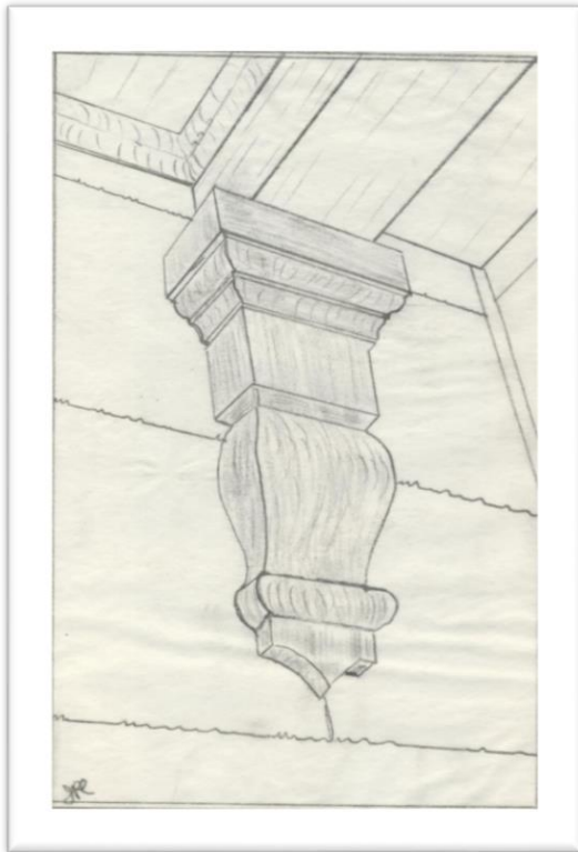
Figures 122 et 123: Deux modèles de consoles. S'il est impossible de fixer une demi-colonne le long d'un mur de façade, on peut poser une jolie console faisant la transition entre le mur et la poutre horizontale. Longueur de 15 à 18 pouces. En plus de la colonne, elle donnera l'impression d'un bon support du toit de la galerie. Croquis de Jean-Pierre Chartier.
