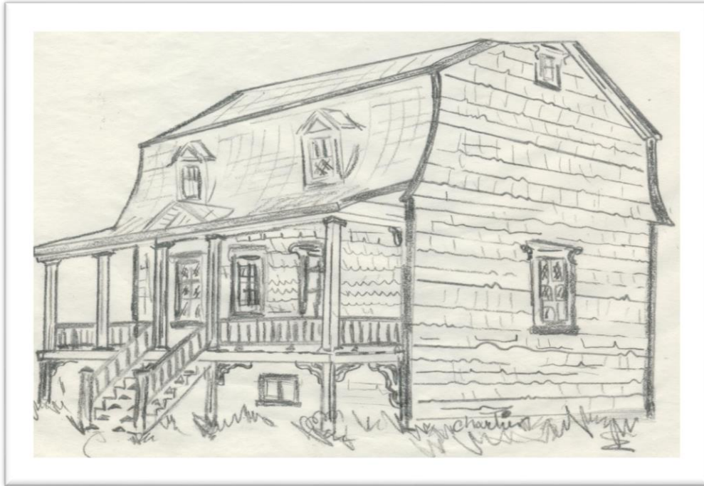
Figure 183: Maison dite mansardée munie de boiseries à l'angle des poteaux de soutien et de la structure de soutien de la plate-forme de la galerie. Croquis de Jean-Pierre Chartier.
