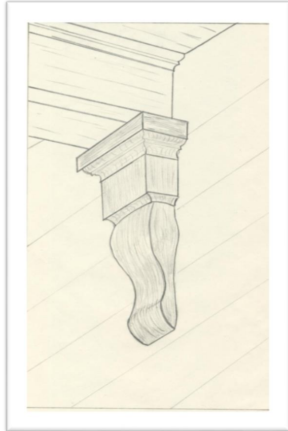
Figures 122 et 123: Deux modèles de consoles. S'il est impossible de fixer une demi-colonne le long d'un mur de façade, on peut poser une jolie console faisant la transition entre le mur et la poutre horizontale. Longueur de 15 à 18 pouces. En plus de la colonne, elle donnera l'impression d'un bon support du toit de la galerie. Croquis de Jean-Pierre Chartier.
