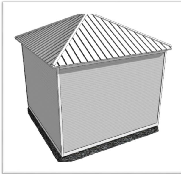
Figure 33: Tôle à baguettes couvrant le toit du type de maison à quatre versants dit en pavillon. Croquis de Daniel Laganière.
